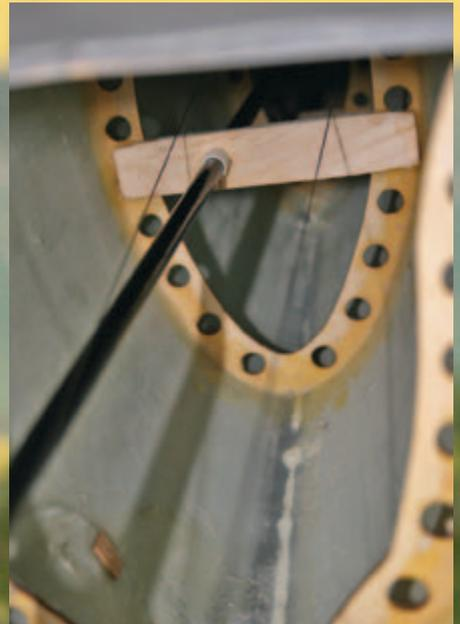
Um eine saubere Höhenruderanlenkung zu erhalten, ist die Höhenruderschubstange am ersten Spant zusätzlich zu lagern.
