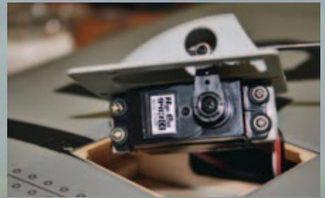
Die Montage der Querruderservos erfolgt auf den Schachtdeckeln.
